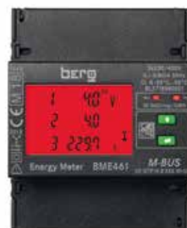
Installationsfehler erkennbar durch Farbumschlag im Display
