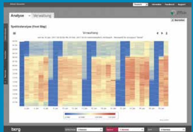
Die Spektralanalyse (Heatmap) visualisiert, an welchen Tagen und bei welcher Uhrzeit der Leistungsbezug besonders hoch ist
